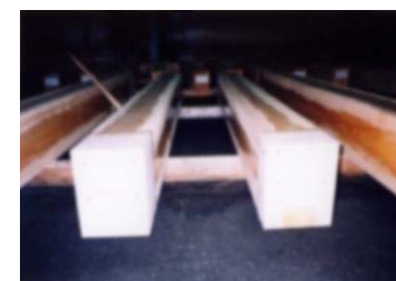
写真7: 木材保管時の材面の乾燥われ想定部分へ保護事例
