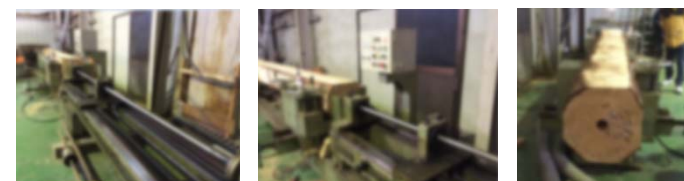
写真5: 木材中心部分穴あけ状況
